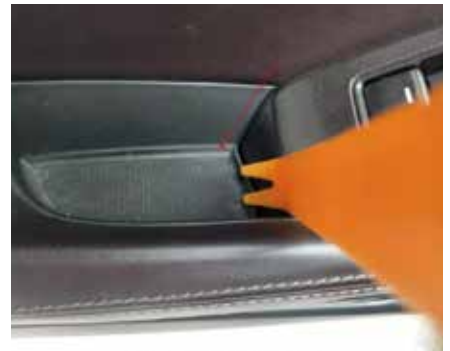
3.把此处螺丝饰板翘开，把里面螺丝拆下
