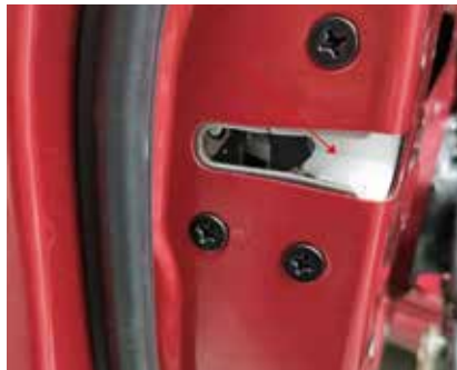
11.把原车锁拆下，安装我司电吸锁
