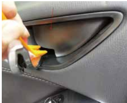
2.把此处螺丝饰板翘开，把里面螺丝拆下
