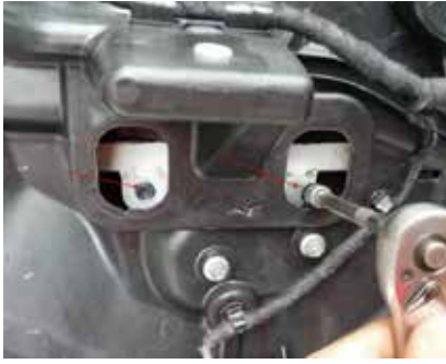
7.把升降玻璃的螺丝调下来，把螺丝拆下
