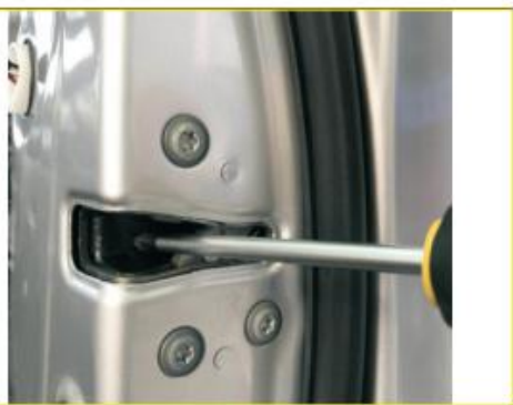
13、电机的调试，安装好后检查锁舌是否全部畅开可以在电机端调松螺母进行调整“拉线调节器”锁舌完全畅开，然后然后用螺丝刀将锁舌拨到第一道锁，锁会自动锁上，如果不能自锁，可调节“拉线调节器”然后可以进行内外锁的开关测试
