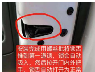
安装完成用螺丝批将锁舌推到第一道锁，锁舌不会自动吸入，可调电机拉线 锁舌不平与锁扣碰撞，调
